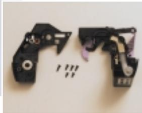
トナーセット、ドラムセットといった消耗品については、製品の分解性を高めるために、消耗品板バネ類の全点スナップフィット化、インサートネジの廃止など分解性に配慮した設計を採用しています。また、ドラムセット超音波接合部品の同種材料化により、リサイクル性を向上させました。さらに給紙カセット等の部品には再生プラスチックを10%使用しています。
